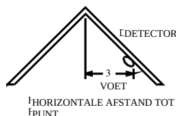
Figuur 4: Aanbevolen installatielocatie voor rook-/warmtedetectoren in kamers met schuine plafonds of puntgevels (helling >20 graden).
