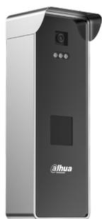
Telecamera AI access ANPR da interno IP54, sensore CMOS 1/1.8", risoluzione 4 MP a 25fps, H.265, ottica motorizzata 2.7~12 mm, IR 850 nm con portata 20 m (10 m ANPR), portata lettura targhe 2.5~6 m, ampiezza varco rilevato 3~4 m, velocità max. rilevata 20 km/h, 1 porta LAN 10/100/1000 Mbps, 1 porta RS485, 2 ingressi e 2 uscite allarme, 1 uscita audio, Wiegand, WDR 140 dB, riconoscimento veicoli, metadati video, OSD, slot TF card ( max. 256 GB), alimentazione 12Vdc <28 W
