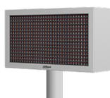
Schermo LED per indicazioni parcheggio da esterno IP54, 1 layer con lettere, numeri, frecce, simbolo disabili..., luminosità 6000 nit (regolabile), 1 porta RJ45 100 Mbps, installazione a palo, alimentazione 100~240 Vac <30 W
