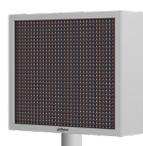
Schermo LED per indicazioni parcheggio da esterno IP54, 2 layer con lettere, numeri, frecce, simbolo disabili..., luminosità 6000 nit (regolabile), 1 porta RJ45 100 Mbps, installazione a palo, alimentazione 100~240 Vac <60 W
