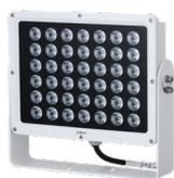
Fari stroboscopici continui per sistemi ITS, 42 LED IR 850 nm, portata illuminazione 18~35 m, angolo di illuminazione 10°x30°, 20 livelli di luminosità, 1 porta RS485, alimentazione 100~240 Vac <60 W
