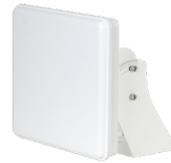
Rilevatore radar narrow wave per sistemi Traffic, frequenza 24 GHz, copertura 1 corsia, rilevamento velocità istantanea (10~250 km/h), portata rilevamento 18~28 m, alimentazione 12 Vdc
