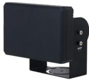
Rilevatore radar multicorsia da esterno IP66 per sistemi Traffic, frequenza 24 GHz, copertura 1~6 corsie fino a 64 veicoli, range rilevamento velocità (5~300 km/h), portata rilevamento 15~60 m, 1 porta LAN 10/100 Mbps, Wi-Fi, 1 RS485, alimentazione 9-15 Vdc <7.2 W
