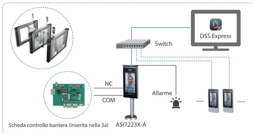
➤ Installare sul tornello per consentire lo sblocco immediato tramite riconoscimento facciale.
