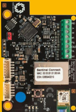
Sentinel Connect è la scheda intelligente che permette di controllare l'impianto nebbiogeno direttamente dal computer grazie al software, scaricabile dal sito [concept-italy.com](http://concept-italy.com), tramite App o portale dedicato.
