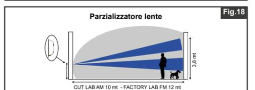
Qualora vi sia la possibilità di transito di piccoli animali domestici nella zona protetta, utilizzare il parzializzatore di lente opzionale, applicandolo sulla lente in modo da lasciar scoperte solo le due zone superiori di rilevazione (Fig.18).
