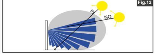
Per protezioni di pareti, evitare che una zona sensibile dell'Infrarosso si trovi a contatto con il muro per non annullare il beneficio del sensore infrarosso a doppio elemento (Fig.13).
