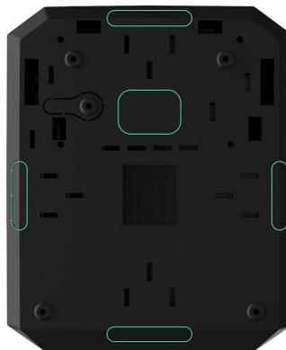
4. Fissare la custodia su una superficie verticale nel luogo di installazione prescelto utilizzando le viti in dotazione. Durante il montaggio, utilizzare tutti i punti di fissaggio presenti sulla custodia. Uno di essi, la parte forata in corrispondenza del tamper, serve per azionare il tamper sul retro della scheda in caso di tentativo di strappare la custodia dalla superficie.
