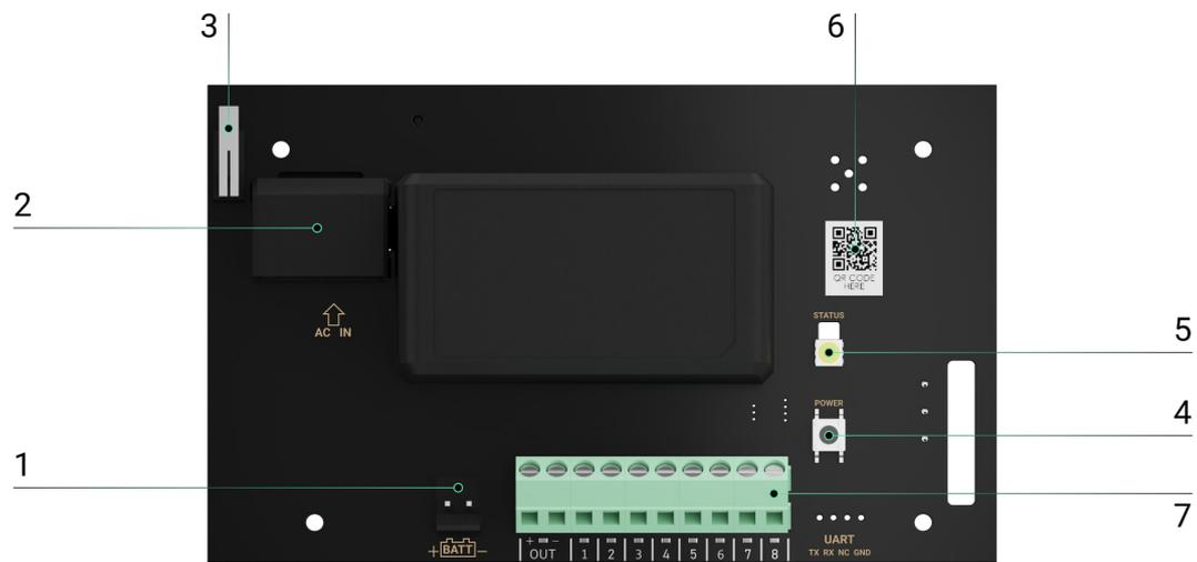
1. Terminali per il collegamento di una batteria di riserva da 12 V $\equiv$ .
