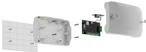
3. Installare il dispositivo nella custodia. Far passare i cavi attraverso i fori preparati in anticipo. Fissare i cavi con le fascette utilizzando gli elementi di fissaggio.
