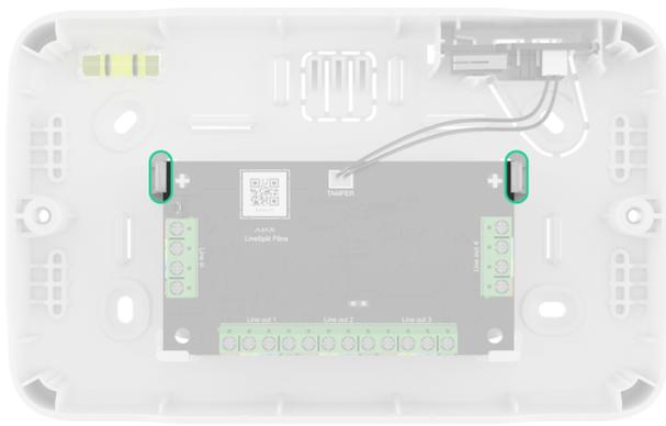
Il dispositivo viene fissato in due posizioni. È possibile ruotarlo di 180°.
