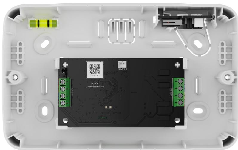
Si raccomanda di installare LineProtect nella custodia Case. La custodia è venduta separatamente ed è disponibile in diverse versioni. È possibile installare un singolo modulo, più moduli o altri dispositivi nella custodia Case.
