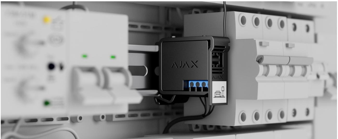
Il dispositivo si collega a una rete di 110 / 230 V~. Grazie alle sue dimensioni (39 × 33 × 18 mm), WallSwitch è facile da posizionare in una presa a incasso, nel corpo di un apparecchio elettrico o in un quadro elettrico. E l'antenna esterna flessibile garantisce la stabilità della comunicazione. Per fissare WallSwitch a una guida DIN consigliamo di utilizzare DIN Holder.
