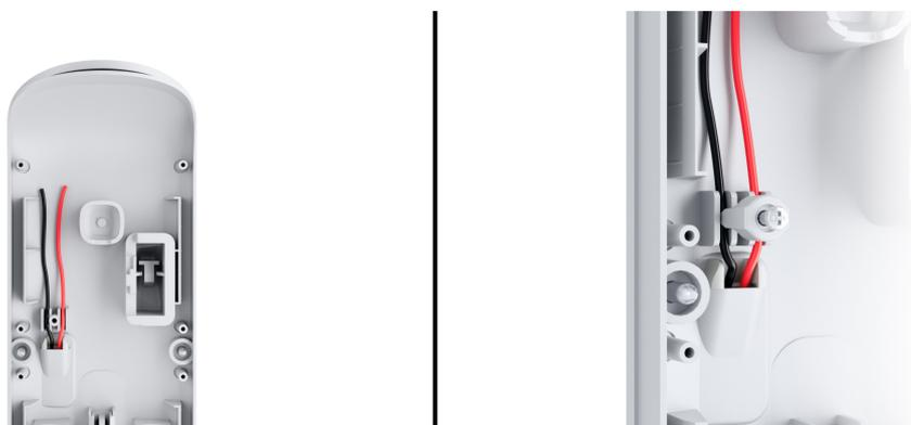
7. Preparazione dei cavi per la connessione. Le estremità dei fili inserite nei morsetti dovrebbero essere stagnate o crimpate con un manicotto speciale. Ciò garantirà una connessione affidabile.
