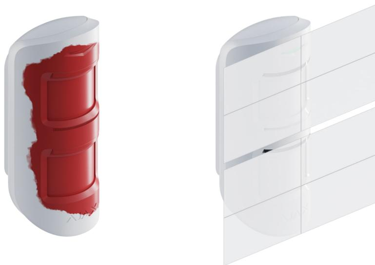
Il **mascheramento** è un tentativo di bloccare la visuale del rilevatore applicandovi della vernice, coprendolo, mettendo un ostacolo davanti alla lente del rilevatore o in qualsiasi altro modo.
