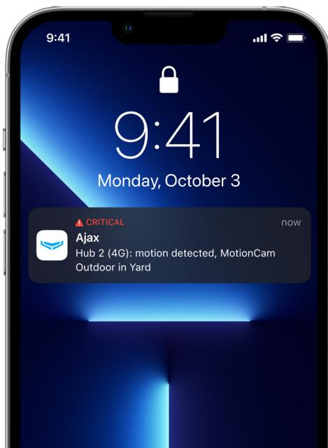
Gli utenti sanno esattamente dove viene rilevato il movimento. Le notifiche contengono il nome dell'hub (nome dell'oggetto sorvegliato), il nome del dispositivo e la stanza virtuale a cui è assegnato il rilevatore.
