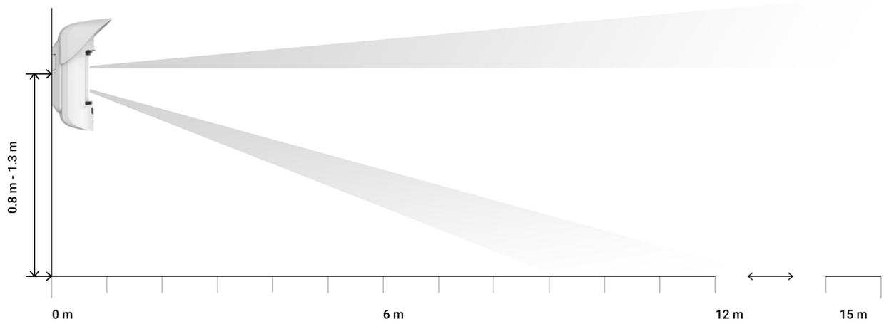
La distanza di rilevamento è regolata utilizzando la barra di scorrimento **Distanza di rilevamento (Detection Distance)** sul pannello posteriore del rilevatore. Quando si sceglie il luogo di installazione, considerare il campo di rilevamento massimo del rilevatore. Questo dipende dalla sensibilità, dalla posizione della barra di scorrimento della distanza di rilevamento, dal tipo e dalla velocità del movimento della persona (correre, camminare) e dalla temperatura ambientale.
