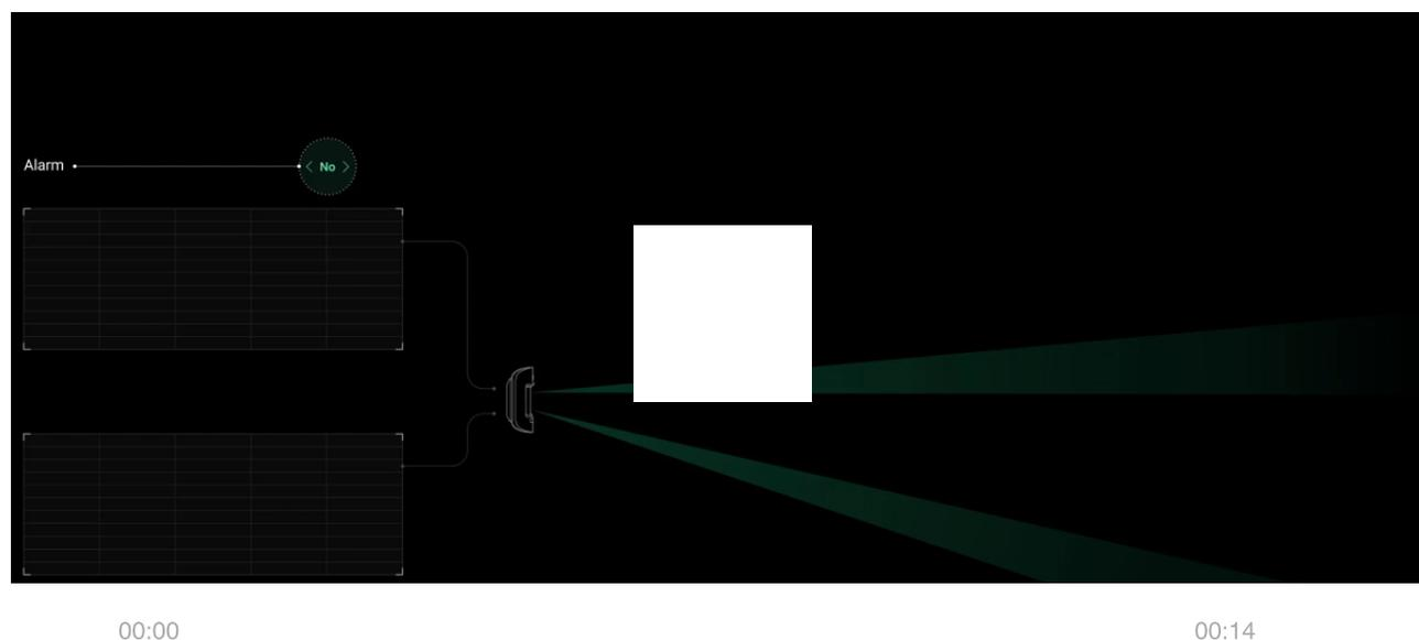
Se impostato e installato correttamente, MotionCam Outdoor ignora gli animali fino a 80 centimetri di altezza. Il rilevatore ha due sensori IR e lancia un allarme solo quando il movimento viene rilevato da entrambi i sensori.
