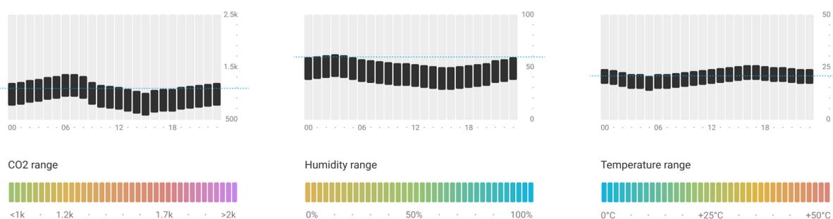
Il rilevatore misura la temperatura, il livello di umidità e la concentrazione di  $\text{CO}_2$  una volta al minuto. Nelle app Ajax, gli utenti possono visualizzare le più recenti misurazioni di LifeQuality e lo storico. Lo storico delle misurazioni è rappresentato da grafici. I grafici mostrano l'andamento del valore di qualità dell'aria selezionato nell'ultima ora, giorno, settimana, mese o anno. Il sistema Ajax memorizza questi dati sul server Ajax Cloud fino a 2 anni.
