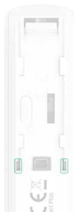
3. Far passare il cavo del rilevatore cablato di terze nella custodia di DoorProtect Plus.
