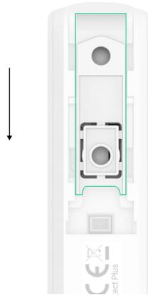
2. Se si utilizza un magnete di grandi dimensioni, rimuovere il pannello di montaggio dello SmartBracket spingendolo e tirandolo leggermente verso il basso come mostrato nel passaggio precedente. Se si utilizza un magnete di piccole dimensioni, smontare l'involucro facendo leva sul retro con un oggetto piatto. A tale scopo, utilizzare un cacciavite a taglio.
