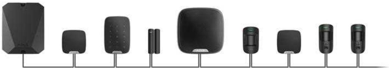
La **connessione ad anello** occupa due uscite dell'hub. Se l'anello si interrompe in un punto, nessun dispositivo verrà disabilitato. L'anello si riconfigura in due linee, che continuano a funzionare normalmente. Gli utenti e l'istituto di vigilanza riceveranno una notifica circa l'interruzione della linea.
