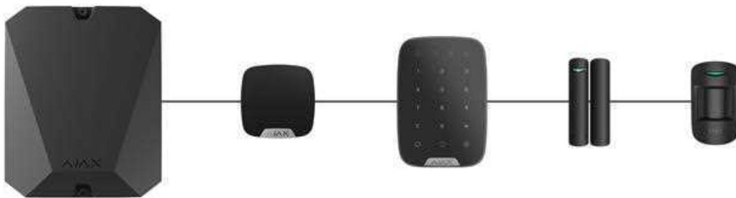
Per la topologia **lineare**, assicurarsi di installare una resistenza di terminazione da 120 Ohm alla fine della linea (è inclusa nel set completo dell'hub). La resistenza di terminazione è collegata ai morsetti di segnale dell'ultimo dispositivo della linea.
