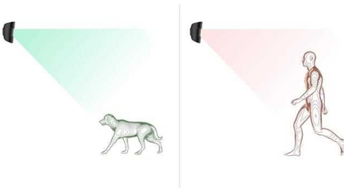
Il rilevatore deve essere installato a 2,4 metri di altezza in campo aperto. Ad esempio, in un angolo in cui la visuale non è bloccata da un armadio o da altri mobili su cui un animale domestico può salire.
