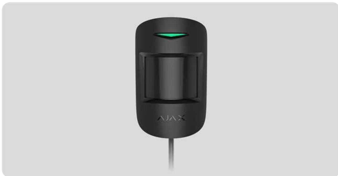
**MotionProtect Fibra** è un rilevatore di movimento cablato con un sensore a infrarossi. Rileva il movimento fino a una distanza di 12 metri. Ignora gli animali fino a 50 cm di altezza e con un peso fino a 20 kg. Progettato per un'installazione all'interno.
