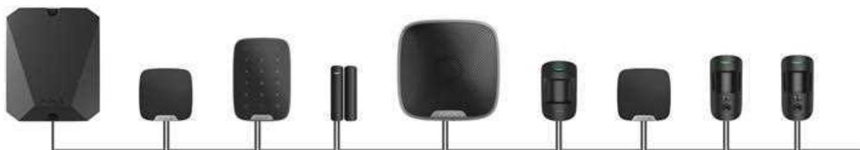
La **connessione ad anello** occupa due uscite bus dell'hub. Se l'anello si interrompe in un punto, nessun dispositivo verrà disabilitato. L'anello si configura in due linee, che continuano a funzionare normalmente. Gli utenti e l'istituto di vigilanza riceveranno una notifica circa l'interruzione della linea.
