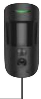
**Fibra** è un protocollo cablato, che garantisce una comunicazione bidirezionale veloce e sicura tra un hub e i dispositivi. Basato su un tipo di **connessione bus**, Fibra consegna allarmi ricchi di dati in un istante: gli istituti di vigilanza e gli utenti sanno quale dispositivo si è attivato, quando e dove è successo. Supportando **fino a 2,000 m** di connessione cablata, Fibra protegge ogni impianto e garantisce la miglior esperienza utente sia per gli utenti che per gli installatori.
