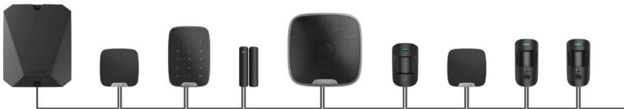
La **connessione ad anello** occupa due uscite bus dell'hub. Se l'anello si interrompe in un punto, nessun dispositivo verrà disabilitato. L'anello si riconfigura in due linee, che continuano a funzionare normalmente. Gli utenti e l'istituto di vigilanza riceveranno una notifica circa l'interruzione della linea.
