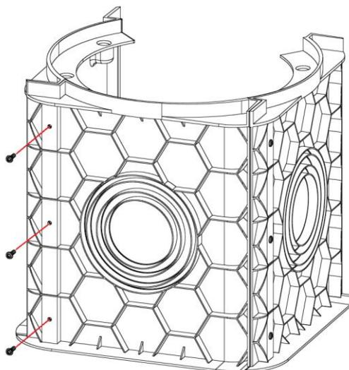
3. Allargare le due pareti opposte per permettere l'inserimento ad incastro dell'ultimo lato del pozzetto
