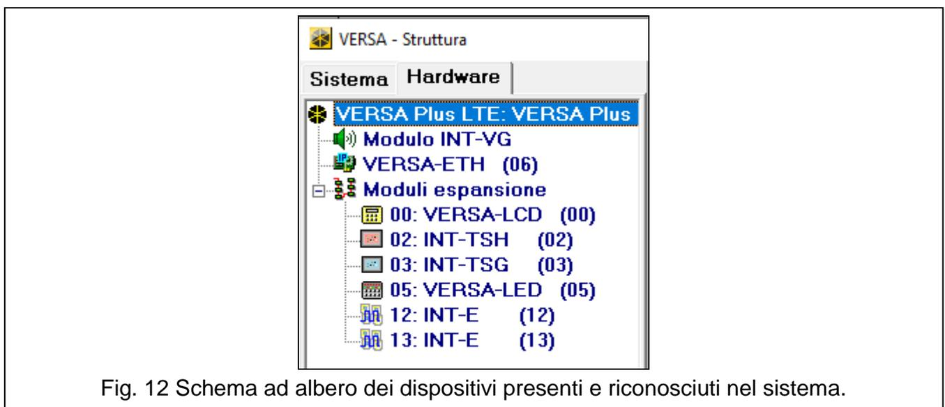
Fig. 12 Schema ad albero dei dispositivi presenti e riconosciuti nel sistema.
