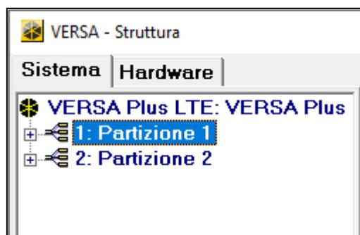
Fig. 6. Software DLOADX: elenco delle partizioni e delle zone struttura ad albero. Scheda "Sistema" finestra "VERSA – Struttura" (esempio di programmazione).
