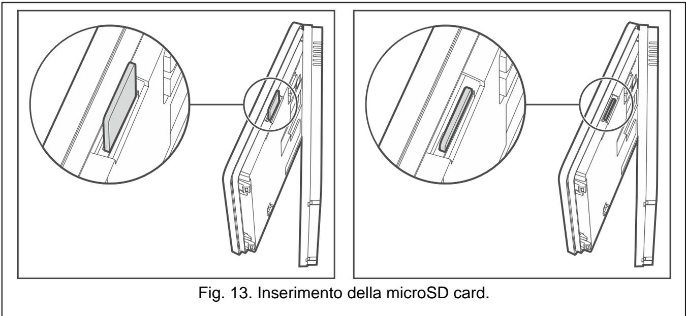
Fig. 13. Inserimento della microSD card.
