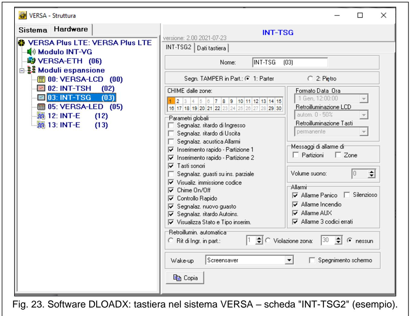
Fig. 23. Software DLOADX: tastiera nel sistema VERSA – scheda "INT-TSG2" (esempio).
