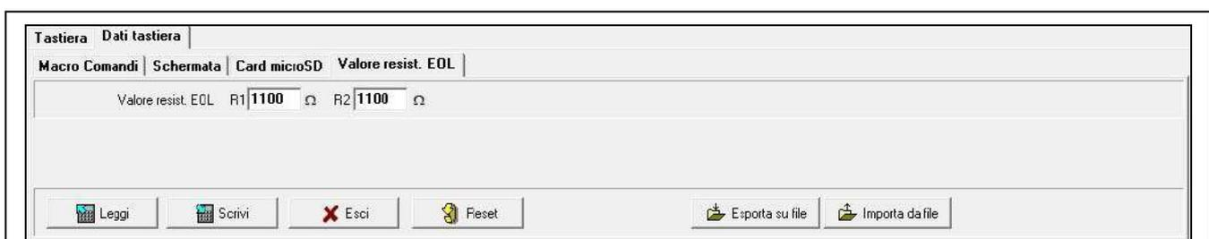
Fig. 21. Software DLOADX: scheda "Valore resist. EOL" (impostazioni di fabbrica).
