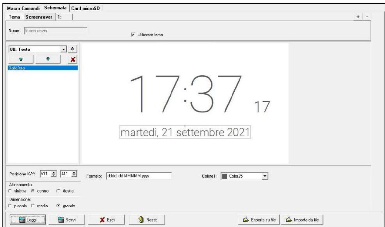
Fig. 17. Software DLOADX: scheda "Screensaver" (impostazioni di fabbrica).
