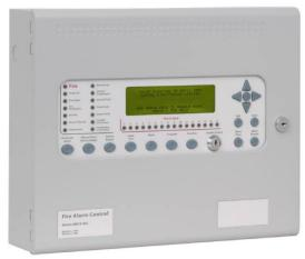
SyncroAS usa una avanzata tecnologia a microprocessore che la rende estremamente flessibile e affidabile. Dispone di 1 loop di rivelazione capace di supportare fino a 127 dispositivi con protocollo Hochiki ESP e nella versione normale (no Lite) e` espandibile a 2 loop tramite la scheda K586H.
