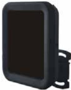
Illuminatore a luce infrarossa con led Super HI-Power a 850nm, portata fino a 200mt, apertura 30°, installazione da esterno IP66, alimentazione 12Vdc/24Vac <18W, temperatura esercizio -30°~+60°, possibilità di montaggio abbinato fino a 3 pannelli con accessorio opzionale IRP-BRK
