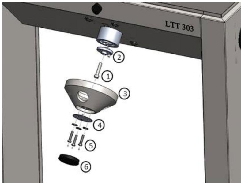
Figura 3.8 Assemblaggio della cabina
