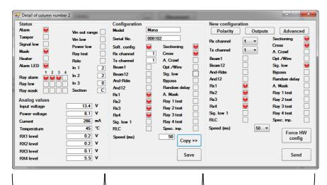
ES. Stato attuale: barriera in allarme con raggi 1-2-3, antimask Livello di allineamento buono solo per raggio 4. ES. Configurazione: attivi 4 raggi Sectioning Crossing Gestione tramite software Speed (Tempo intervento)=50ms
