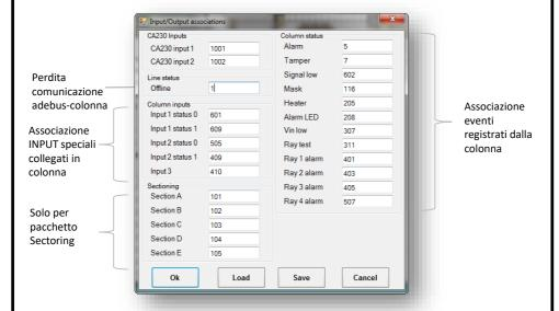
Tipicamente vengono utilizzati relé singoli per uscite di ALARM, SIGNAL LOW di ogni colonna. Mentre vengono usati un relé in condivisione per uscita TAMPER e OFFLINE per tutte le colonne. I Relè lavorano con logica OR, se un relé è associato a uscite di più colonne:, li relè viene eccitato se almeno un'uscita cambia stato.
