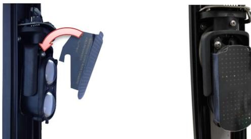
È sufficiente l'applicazione del filtro solo sul TX, non occorre ripetere l'operazione anche sull'RX.
