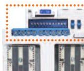
Tutti i componenti necessari alla regolazione del sensore e le impostazioni sono di colore blu.
