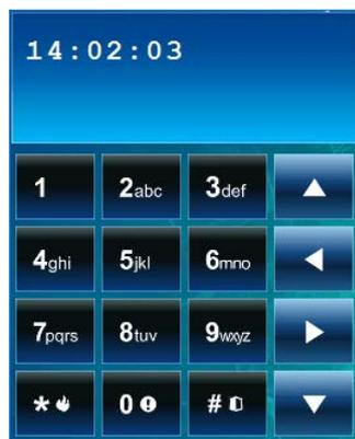
La tastiera virtuale (Terminale) permette l'utilizzo e la programmazione del sistema di allarme nella modalità classica, così come avviene in una tastiera LCD. La modalità di utilizzo
