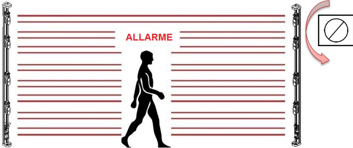
Regolando il potenziometro in senso antiorario si aumenta il tempo di intervento fino a 500ms. In questa condizione si garantisce l'allarme di una persona che attraversa camminando la barriera, col vantaggio di escludere la possibilità di eventuali falsi allarmi (ex. animali).
