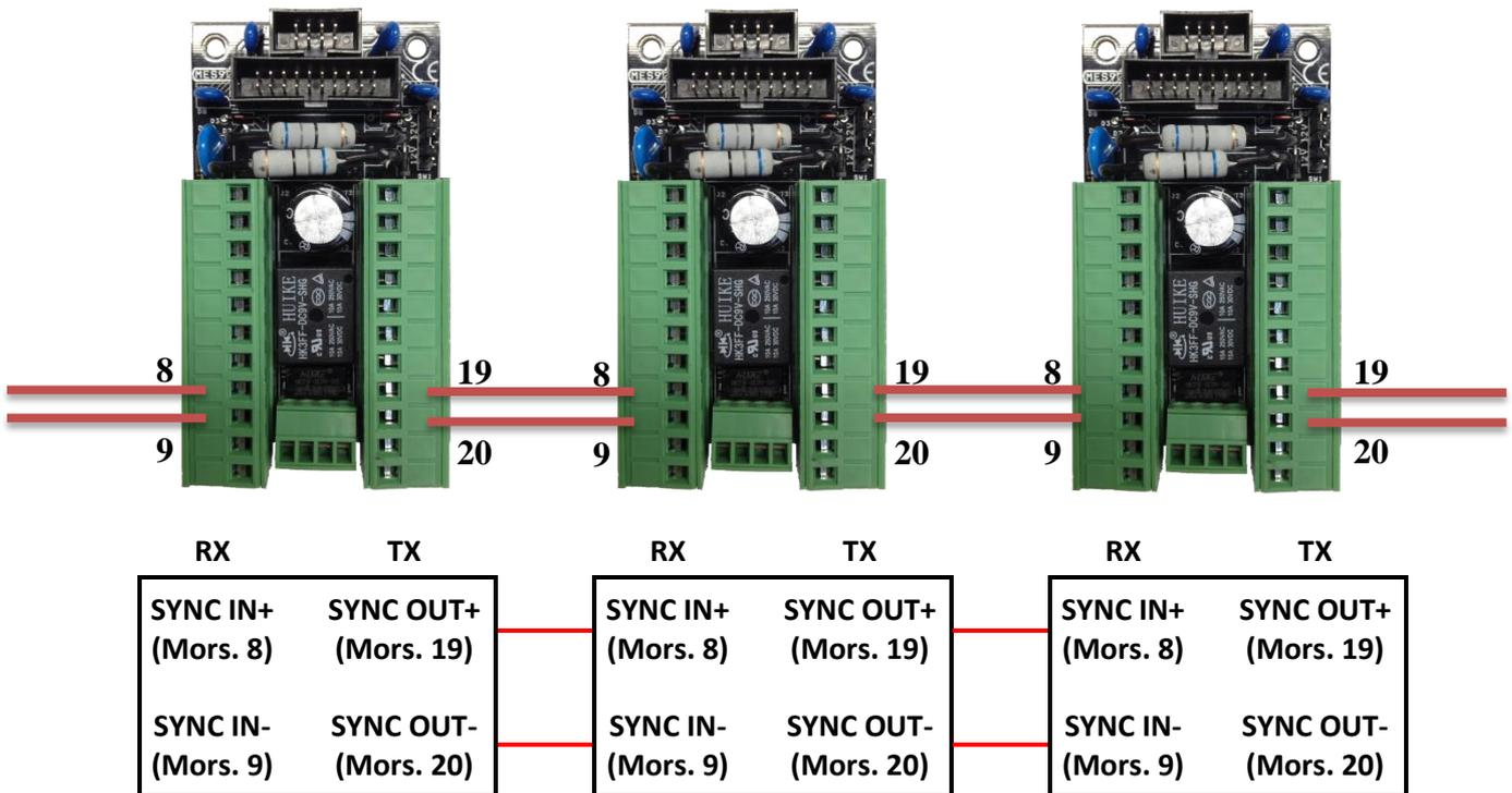
I sincronismi sono da collegare come da schema sopra riportato. Il Sync Out corrisponde alla parte di colonna TX e dovrà essere collegato al Sync In della colonna RX opposta. È necessario inoltre collegare il negativo di alimentazione in comune tra le colonne e utilizzare per i sincronismi cavi schermati (2x0,22) preferibilmente separati dall'alimentazione, con la calza collegata al negativo.
