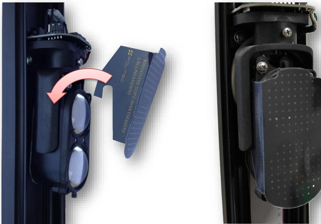
È sufficiente l'applicazione del filtro solo sul TX, non occorre ripetere l'operazione anche sull'RX.
