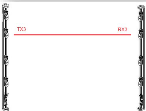
Mettere in TEST l'ottica TX3 e RX3 e procedere alla taratura come precedentemente spiegato.
